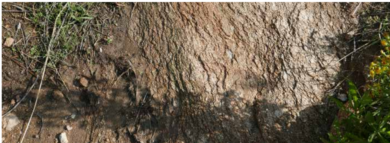
Figura 41 – La roccia "granitica" degradata in prossimità della costa (arenizzazione) – ph M. Bastogi
